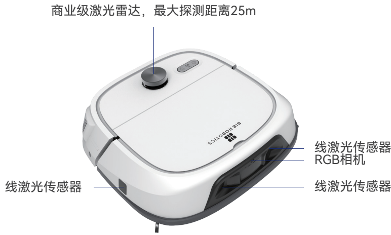
商业级激光雷达，最大探测距离25m
